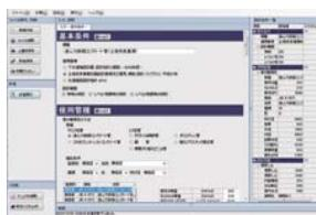
『土地改良事業計画設計基準及び運用・解説 設計「パイプライン」』、『下水道施設計画・設計指針と解説』などに基づいて、とう性管、不とう性管を対象として埋設深の検討および、常時、地震時(レベル1、レベル2)における管体の安全性の照査を行います。管体の安全性の照査では、土圧や自動車荷重等の活荷重による外圧や、静水圧や水撃圧等による内圧に対して安全な耐圧強度を有する管種を選定します。
