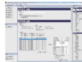
『土地改良事業計画設計基準及び運用・解説 設計「パイプライン」』などに基づき、とう性管、不とう性管を対象として屈曲部、分岐部、片落ち部、T字管、弁栓部、鉛直Sベンド管に対してスラスト力の検討を行い、対策工の要否を判定します。また一体化長の計算として、「溶接・接着・溶着等による接合」および「離脱防止継手による接合」が選択できます。
