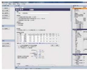
『土地改良事業計画設計基準及び運用・解説 設計「パイプライン」』、『下水道施設の耐震対策指針と解説』などに基づいて、とう性管、不とう性管を対象として埋設管の縦断方向の耐震設計を行います。また、液状化の判定および液状化による浮き上がりの検討や、人孔と管きょ、または管きょと管きょの接合部の検討、管軸方向の強度検討を行うこともできます。
